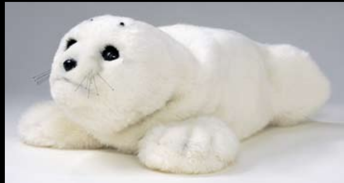
PARO © A.I.S.T. Robotsælen "Paro" interagerer med mennesker ved at reagere på fysisk kontakt og stemmer. Den kan hjælpe og trøste mennesker, der lider af stress eller demens. På Københavnske demenscentre bruges 12 Paro robotter for at forhale demensudviklingen.
