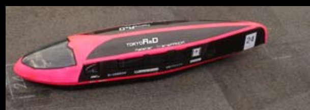
Econo Move kan køre 80km på et 144Wh batteri, en energimængde svarende til 16cm 3 benzin © Meister
